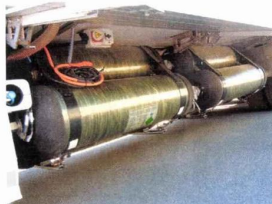
12 réservoirs à hydrogène de Plastic Omnium type 4 de 150 l permettent un emport total de 46 kg, le plein se fait en 15 minutes sous 350 bar. L'autonomie théorique est estimée à 480 km.
