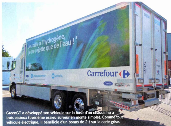
12 réservoirs à hydrogène de Plastic Omnium type 4 de 150 l permettent un emport total de 46 kg, le plein se fait en 15 minutes sous 350 bar. L'autonomie théorique est estimée à 480 km.
