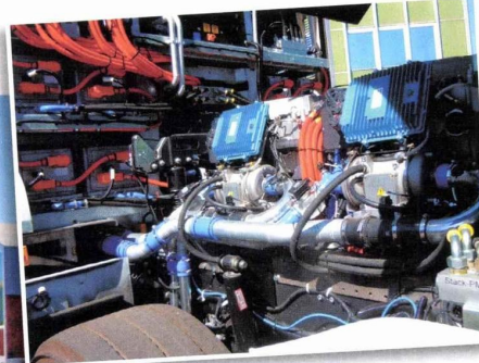
GreenGT a mis au point une pile à combustible hydrogène à membrane électrolyte polymère, constituée de 2 stacks horizontaux de 85 kW.
