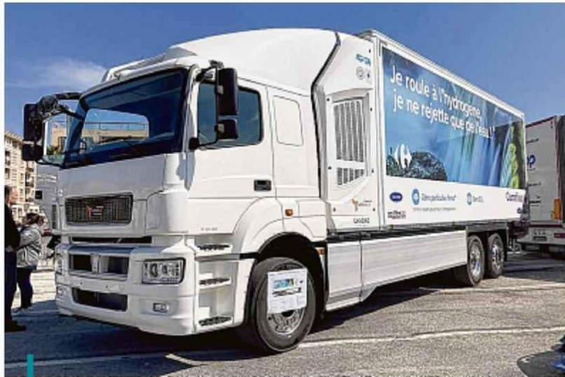
Le camion de la catégorie 44 tonnes est le premier à utiliser la technologie de la pile à hydrogène qui lui procure une autonomie de 500 km. Il a été conçu à Signes et présenté à Toulon. /PHOTO J.-L.C.
