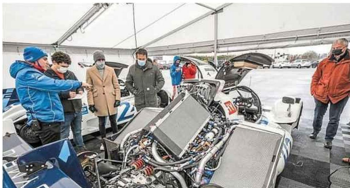
Sous le capot, ce n'est pas tout à fait la même chose qu'avec un moteur thermique. Les importants radiateurs viennent refroidir la pile à combustible.
