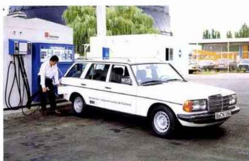
Break 280 TE W123 de recherche équipé pour le fonctionnement du mélange essence/hydrogène. Les premiers essais d'utilisation directe de l'hydrogène n'apportèrent pas de progrès notable en termes de consommation et de pollution.
